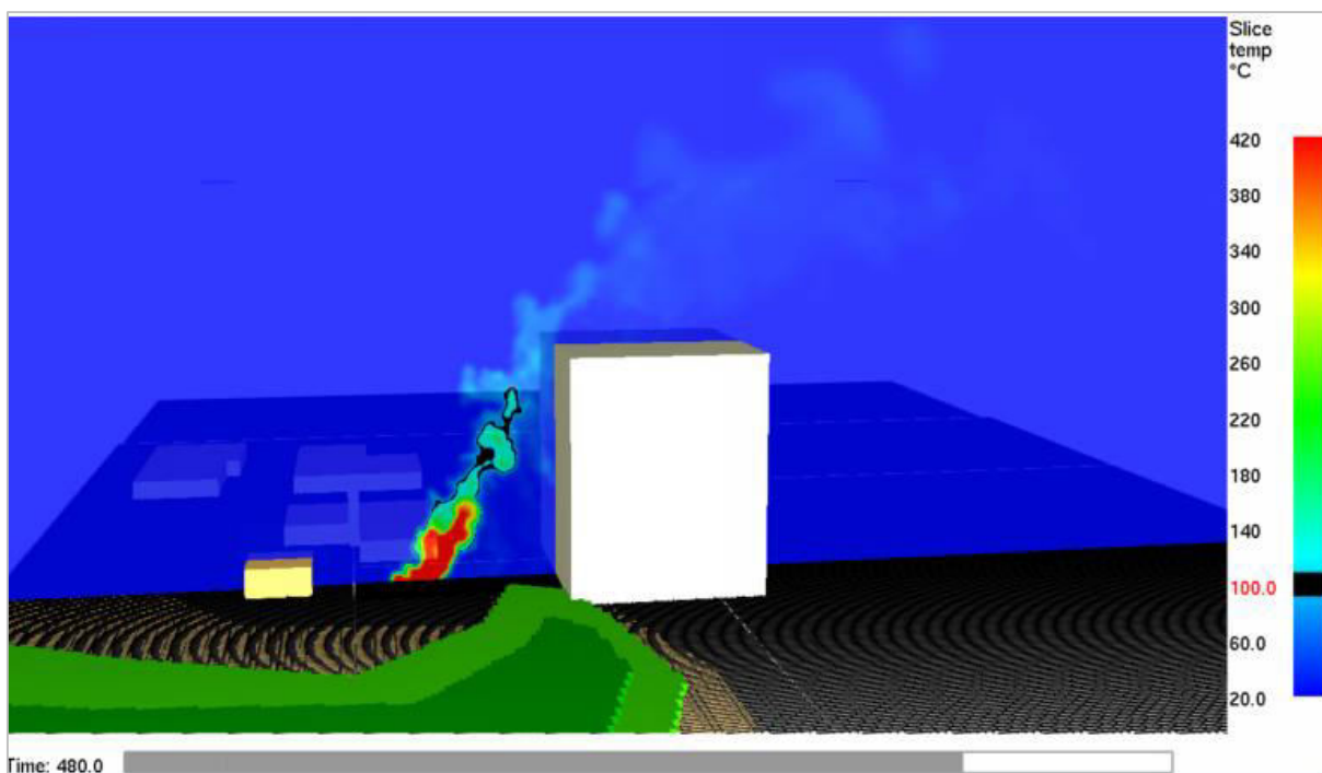
Figur 15. Direkt flampåverkan vid avstånd 25 m från brandens mittpunkt. Fasaden riskerar ingen direktpåverkan.
